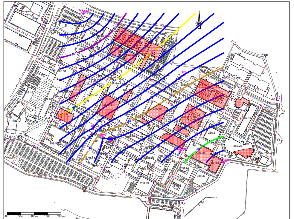
Mittelwasser April 2011 (mit Wasserhaltung)
